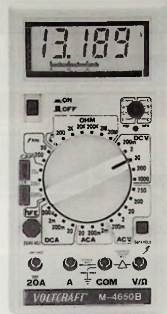
Afb. 8 Voltcraft's M-4650B heeft een aantal ongebruikelijke meetfuncties, zoals het meten van de versterkingsfactoren van transistoren.
