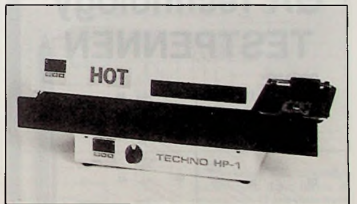
Afb. 13 Een eenvoudige automatische doorvoeren voor het solderen van kleine reeksen printen.
