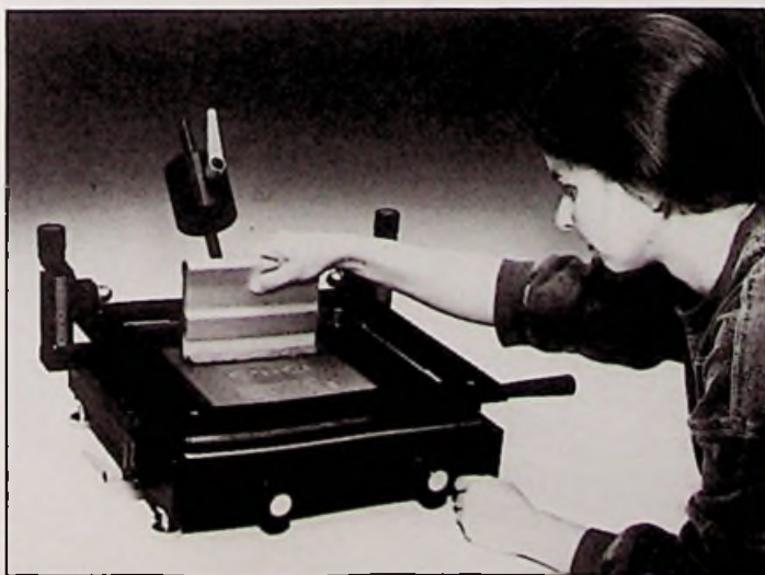
Afb. 4 De werkwijze bij het met de hand zeefdrukken van SMD-prints.
