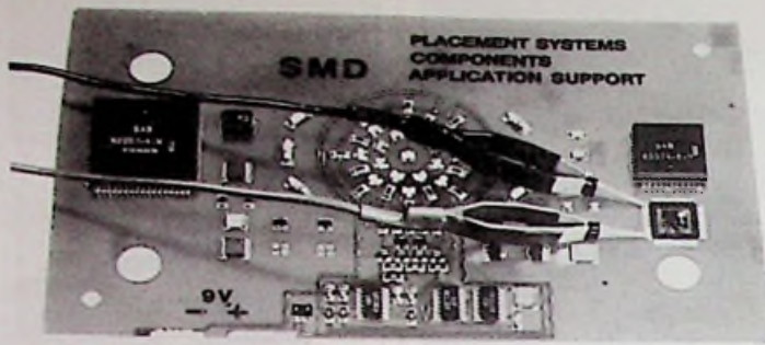
Afb. 15 Deze testpennen van Fischer klemmen zich zelfs rond de aansluitingen van PLCC-IC's vast.
